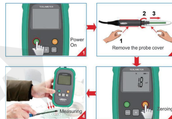
Obr. 3.4 Schéma základních kroků měření
